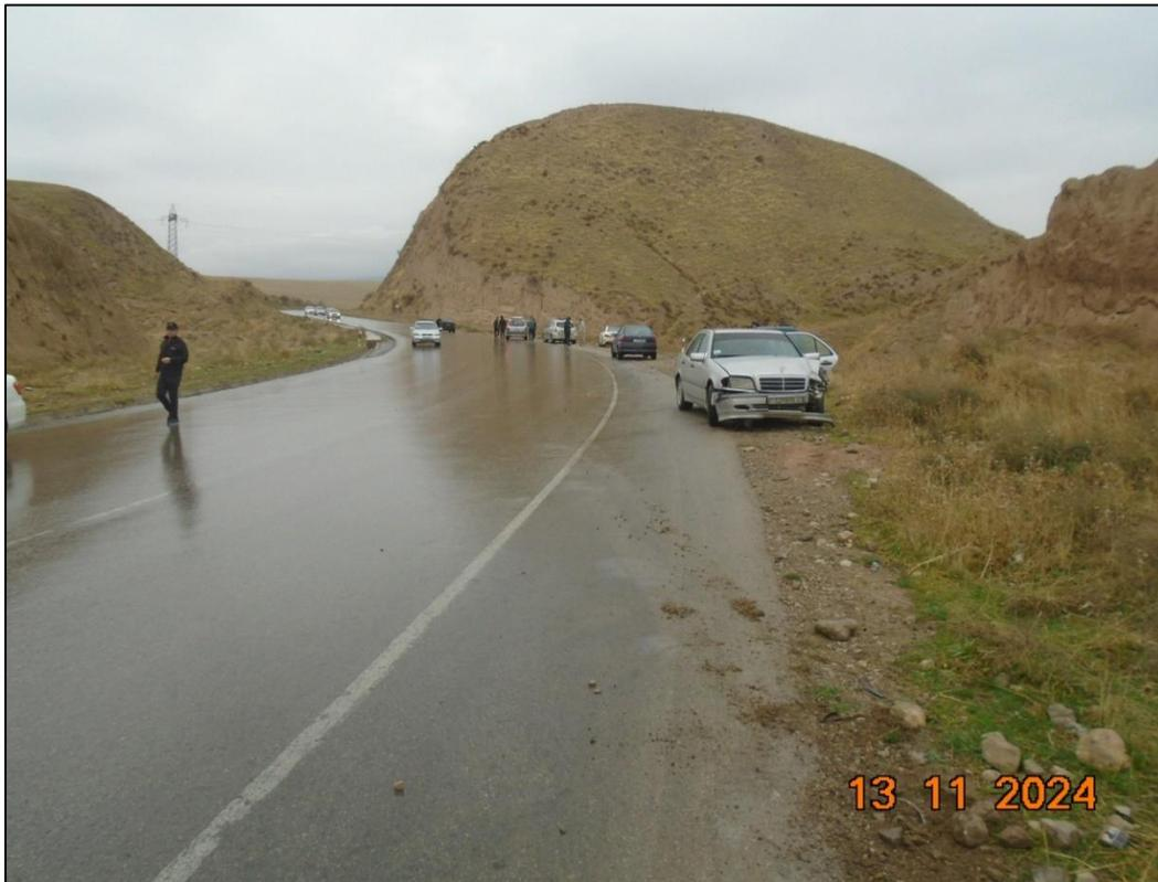
Фото 3. Км 84 ЛС. Пример аварии на момент посещения участка, на краю крутого поворота без ограждения, требуемого в срочном порядке, предупреждающих знаков «Крутой поворот/ограничение скорости», разделительных столбиков/направляющих шевронов, двойной сплошной линии по центру.
